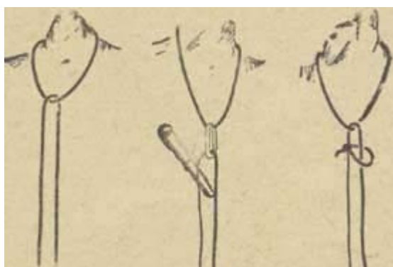
Рис. 11. Способы закрепления веревки для спуска.
