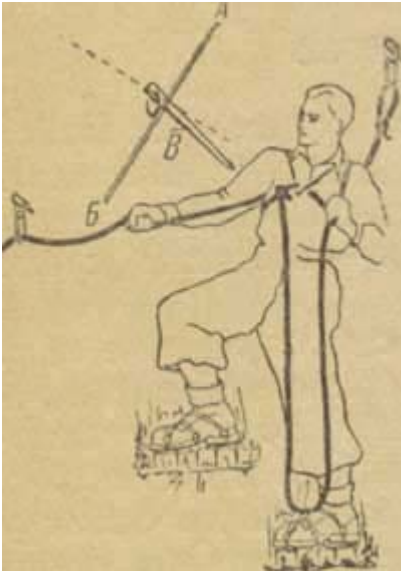
Рис. 18. Охранение на ледяном склоне через крюк с самоохранением. А-Б-линия склона, В-положение правильно забитого крюка.
