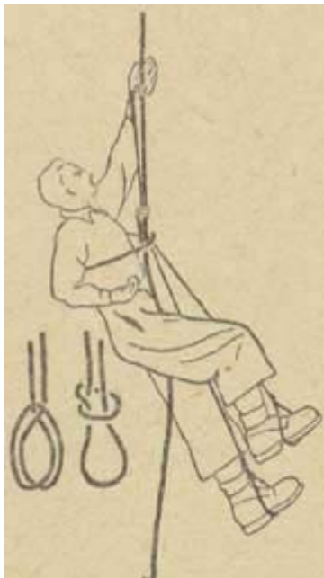
Рис. 8. Подъем на петлях с узлом Пруссика.
