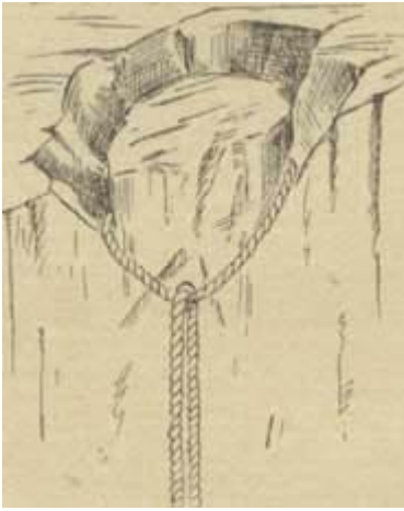
Рис. 25. Веревка, закрепленная для спуска на ледяном столбе.
